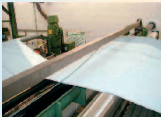
Vakuumsaugbalken zur Vortrocknung von Stoffbahnen in der Textilindustrie Bild: Envirotext GmbH
